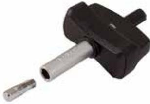
Die Glasklemmbacken in InfinitySlide 69kgmüssen unbedingt mit 10 Nm Drehmoment festgedreht werden, da es sonst vorkommen kann, dass das Glas über die Zeit nach unten rutscht und schließlich auf dem Boden steht.
